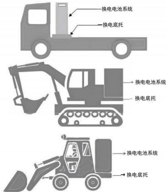
图1 换电电池系统布置形式和连接示意图
