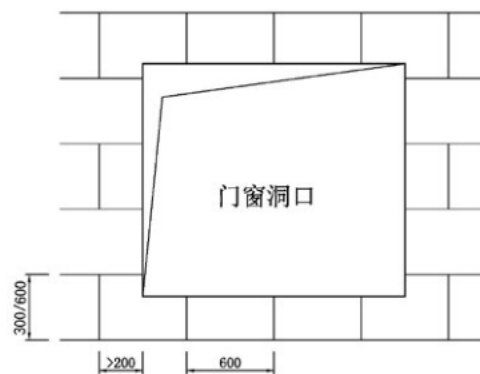
图 6.4.3-3 门窗洞口岩棉复合板排板示意 (单位: mm)
