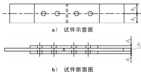
图 G.2 两栓连接试件加工示意图
