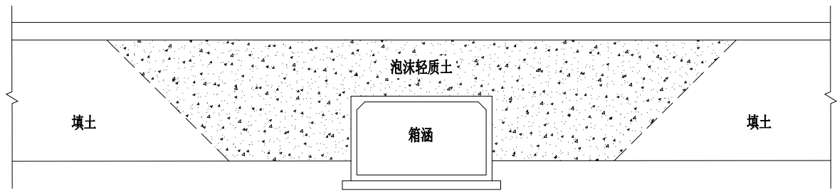
图15 涵洞背部局部浇筑泡沫轻质土
