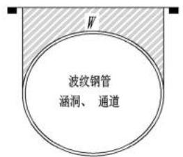
图 C.1 波纹管结构上填土的重力作用范围示意图
