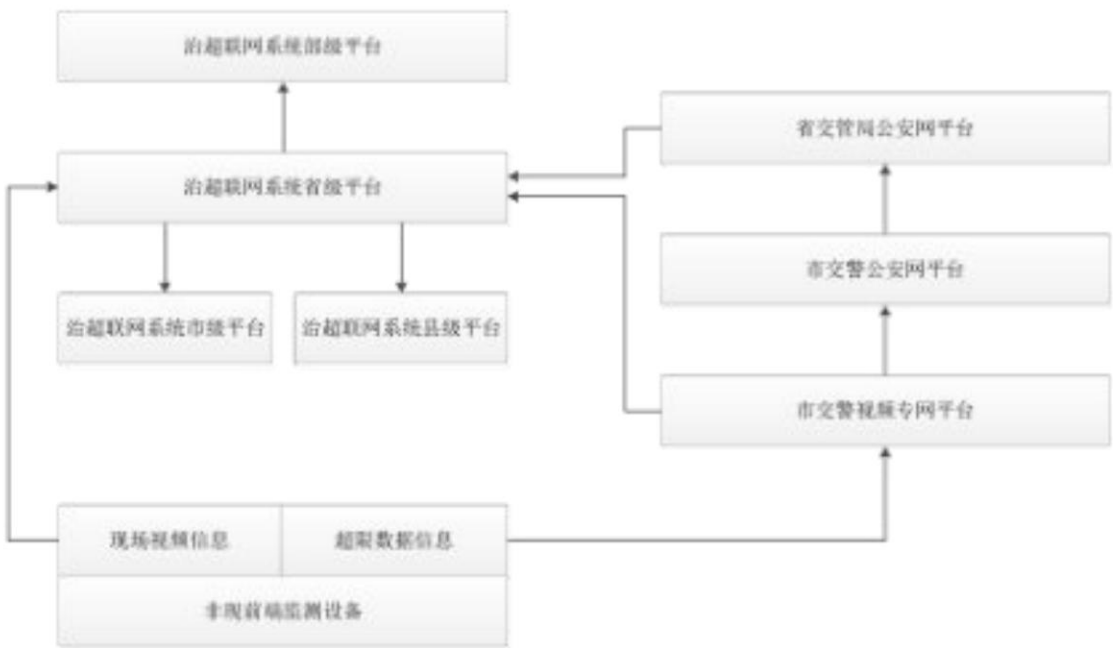
图 2 非现场执法系统数据传输架构示意图
