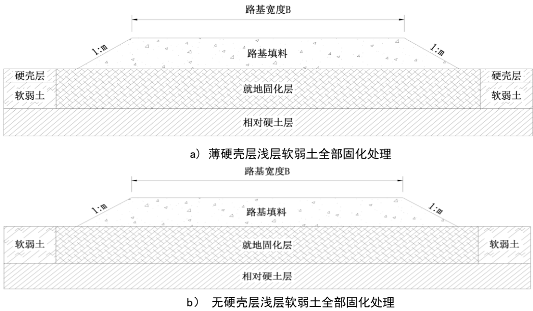
图3 浅层软弱土全部固化处理示意图
