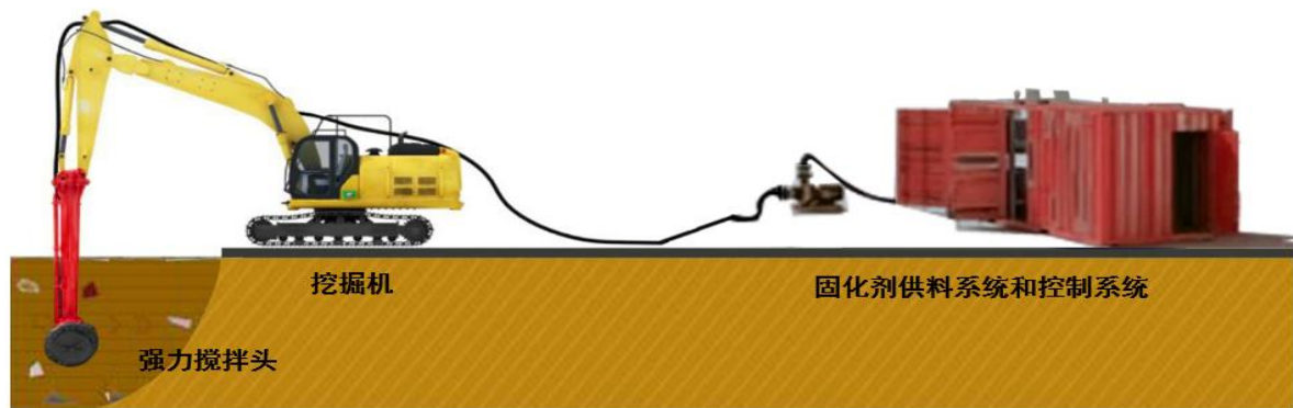
图1 强力搅拌就地固化系统示意图
