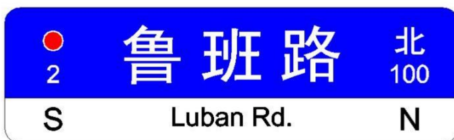
图 B.13 B型路头尾表示示意图 (单位: mm)
