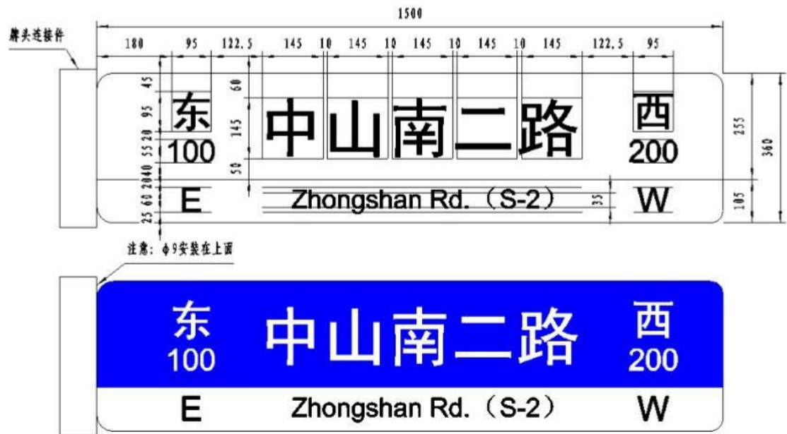
图 B.3 A型5字体布置图 (单位: mm)
