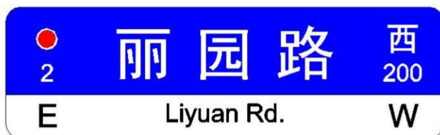
图 B.14 C型路头尾表示示意图 (单位: mm)
