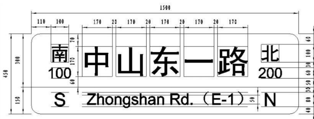
图 B.5 B型4字体布置图 (单位: mm)
