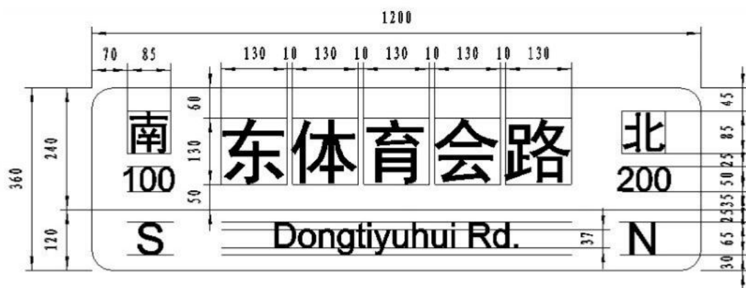
图 B.9 C型4字字体布置图 (单位: mm)
