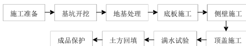
图11 混凝土蓄水池典型施工流程图
