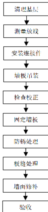
图 5.2.1 自保温墙板安装流程图
