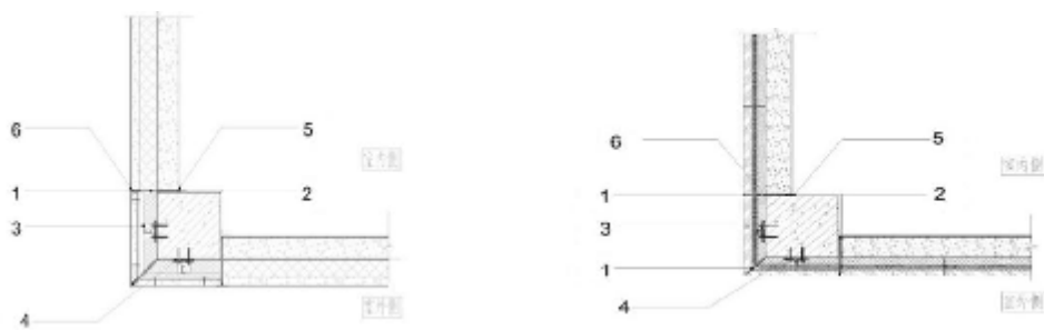
图7 保温装饰复合预制混凝土外墙挂板系统阳角做法示意图
