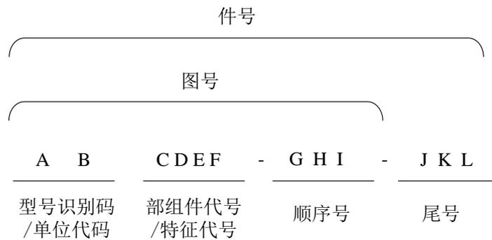
图C.1 基本图样编号方法
