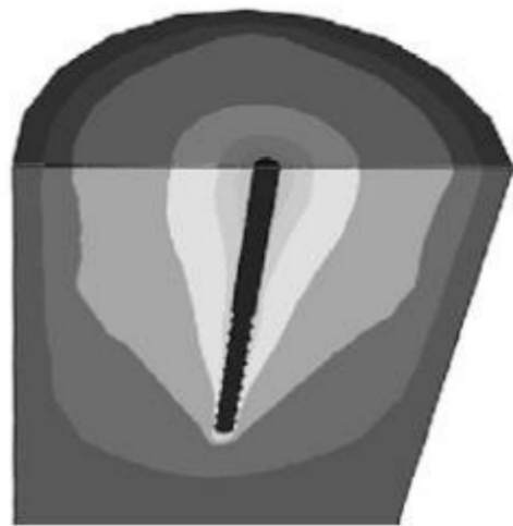
图 1 螺杆灌注桩桩周土体中的“应力泡”
