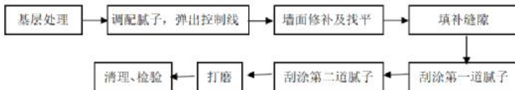
图6.2.2 瓷砖墙面翻新用腻子施工工艺流程图
