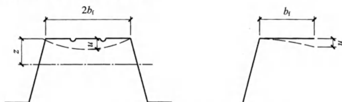
图 2 压型钢板翼缘的卷曲变形示意图
