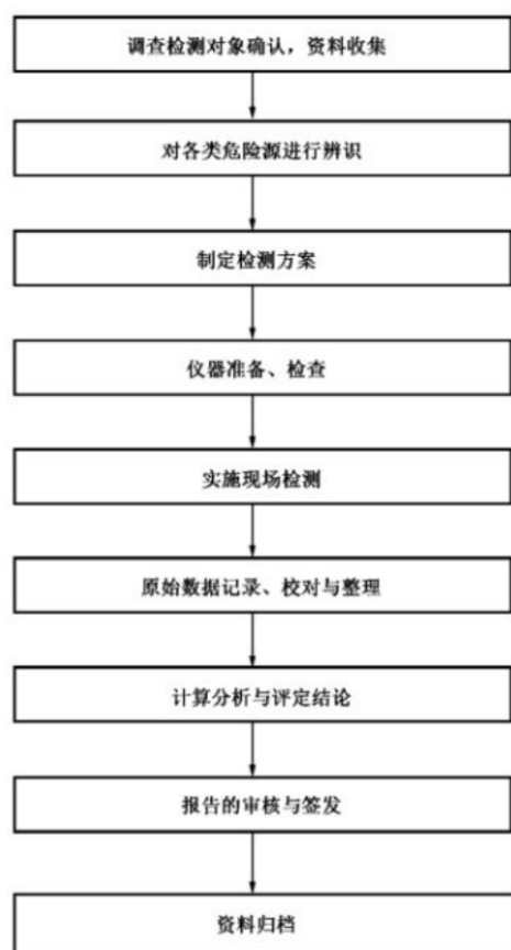
图 1 城市轨道交通系统防雷装置检测流程图
