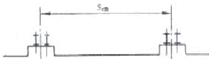
附图 1.7 大型装卸桥轨道
