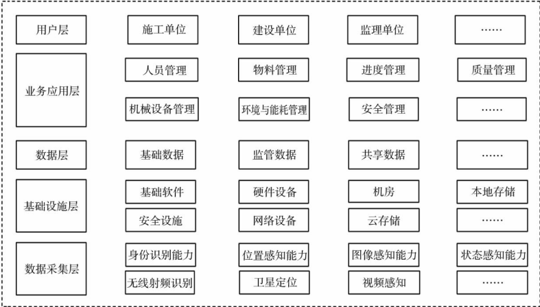
图 4.2.1 智慧工地管理平台架构图
