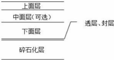
图 4.7.3 一般采用的碎石化后沥青加铺结构形式
