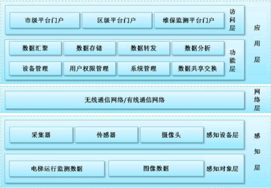
图2 电梯运行安全监测信息管理系统体系结构示意图
