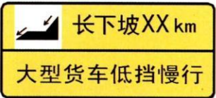
图6 连续长下坡坡顶处警告标志组合设置示例
