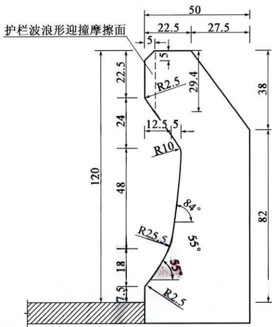
图 14 SS 级消能减速护栏断面构造图(尺寸单位:cm)
