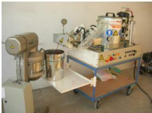
图 A-1 WLB10 实验室用沥青发泡设备 图 A-2 WLB10 实验室用沥青发泡设备简图
