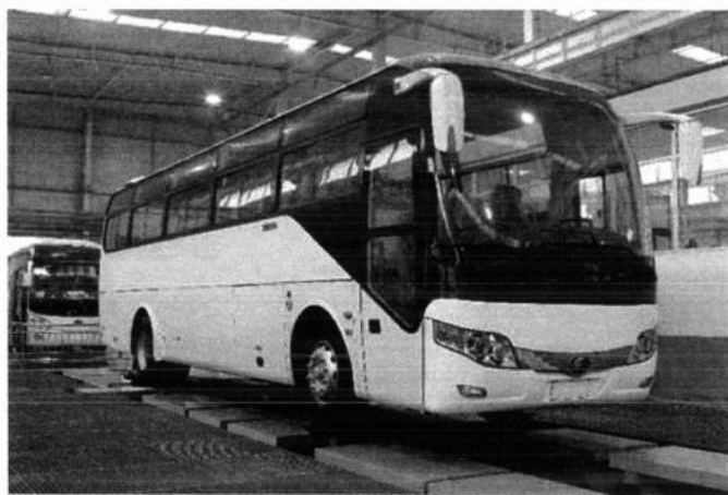
图 3 汽车轮耦合道路模拟试验
