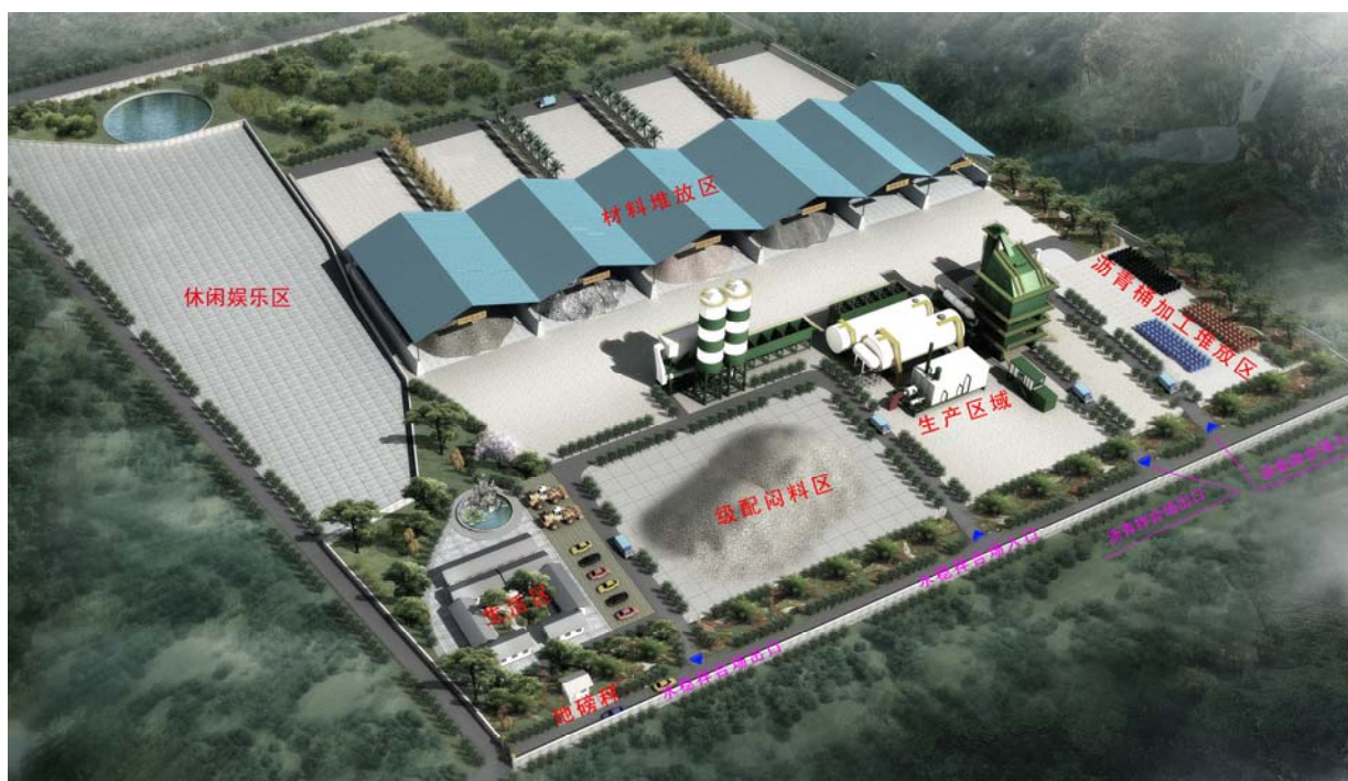
图A.3 养护站生产区平面布置示意图
