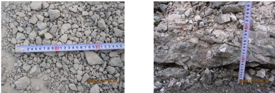
图4 共振碎石化比对板
