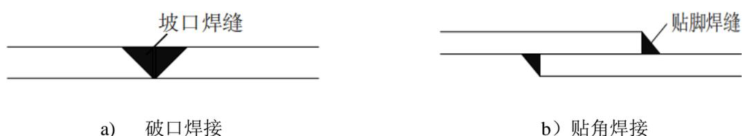
图3 焊接连接形式
