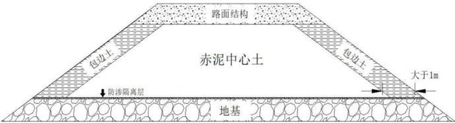
图 1 赤泥路基横断面结构设计示意图
