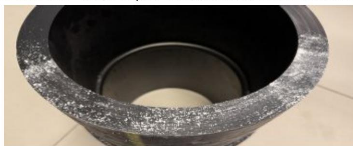
图 D.2 微粒污染（滑石粉）施加
