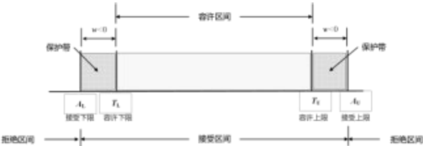
图4 双侧保护带的拒绝示意图
