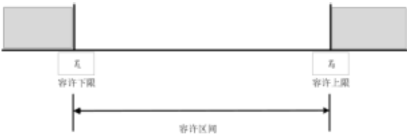
图 D.3 同时含有容许上限 T_U 和容许下限 T_L 的双侧区间示意图
