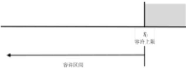
图 D.2 含单一容许上限 T_U 的单侧区间示意图
