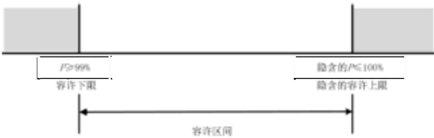
图 D.5 含容许下限 T_L 和一个隐含的容许上限 T_U 的双侧区间示意图
