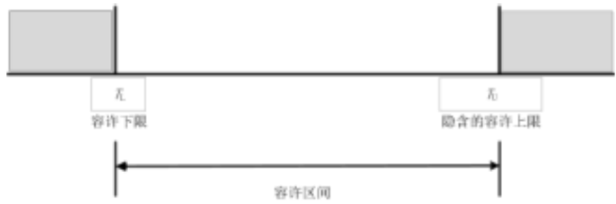
图 D.4 含容许下限 T_L 和一个隐含的容许上限 T_U 的双侧区间示意图
