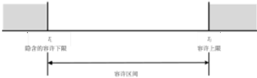
图 D.6 含一个隐含的容许下限 T_L 和容许上限 T_U 的双侧区间示意图
