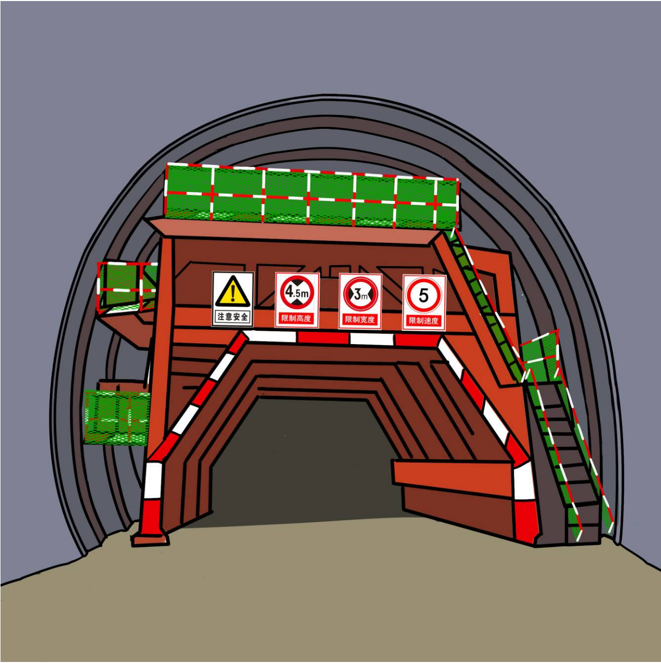
图E. 7 隧道工程作业台车安全标志设置示意图
