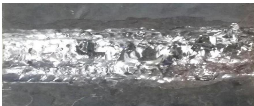
b) 不合格：过度冲击，造成表面损伤
