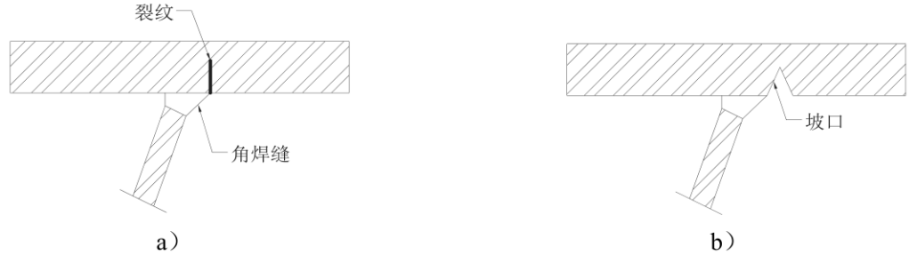
图 H.2 贯穿型疲劳裂纹补焊流程
