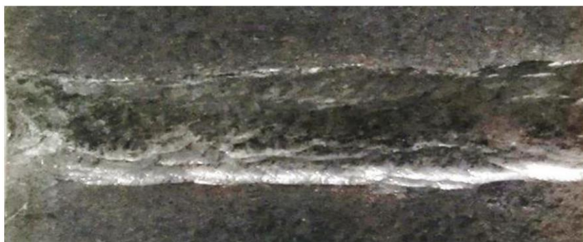
c) 合格：充分覆盖，凹槽连续光滑
