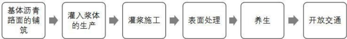
图 1 灌浆复合沥青路面施工程序
