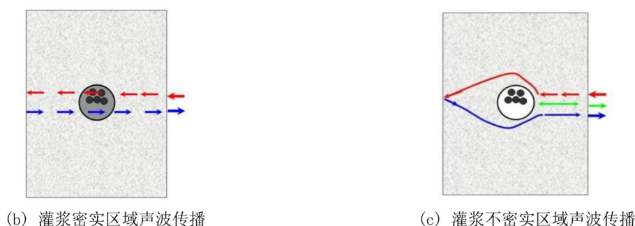
图6 声波侧面单点反射散射法检测工作布置示意图
