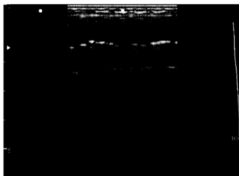
图 D.9 过焊电熔接头相控阵超声检测图谱
