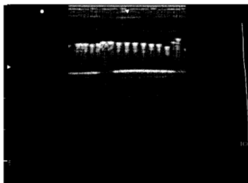
图 D.5 电阻丝错位的电熔接头相控阵超声检测图谱
