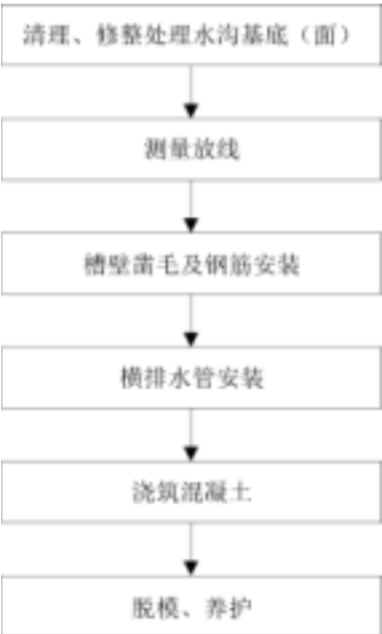
图4 现浇边沟施工工序流程图
