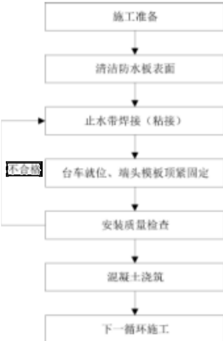
图9 背贴式止水带施工工序流程图
