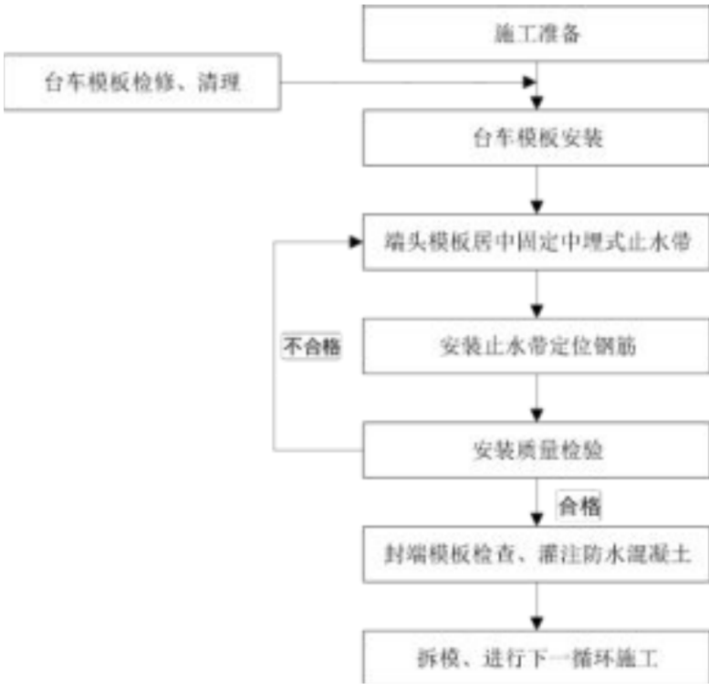
图10 中埋式止水带施工工序流程图
