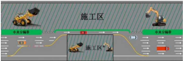
图B. 3 半幅封闭半幅单向通车的借用中间带的交通组织方案
