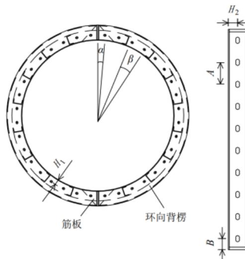
图C.1 圆柱模板法兰孔结构示意图
