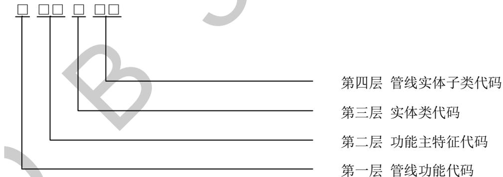
图2 管线要素代码结构示意图
