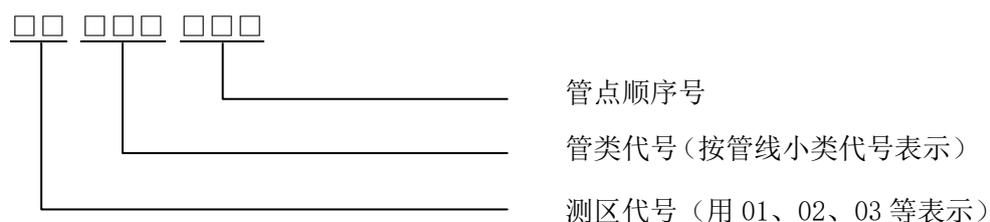
图1 管点编号结构示意图
