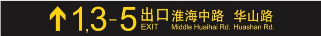
图 29 设置在站厅、出口的出站导向标识以及站厅不连通时的站台出站导向标识
