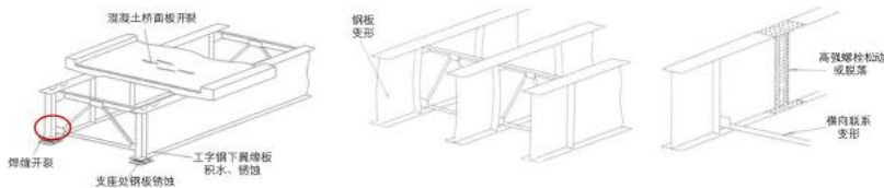
图1 典型病害（工字型钢梁-混凝土桥面板结构）
