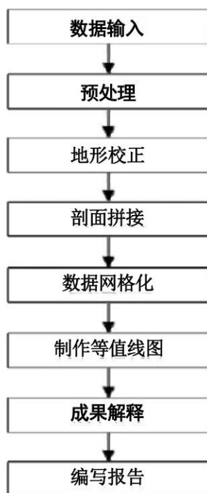
图4 大功率电测深法数据处理流程
