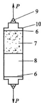
图2 钻取试件的直接拉力试验
