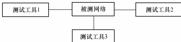
图 7.3.1-4 QoS 功能检测结构示意图
