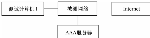
图 7.3.1-7 AAA 功能检测结构示意图
