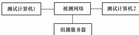
图 7.3.1-10 组播功能检测结构示意图
