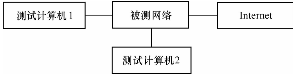
图 7.3.1-6 NAT 功能检测结构示意图
