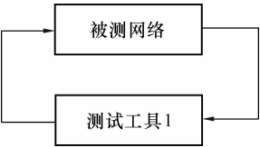
图 7.3.2-5-2 网络传输时延测试结构示意图
