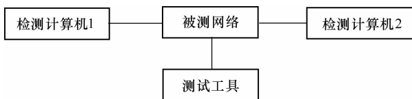
图 7.3.1-1 子网划分检测结构示意图
