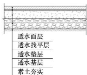
图4 透水铺装结构示意图
