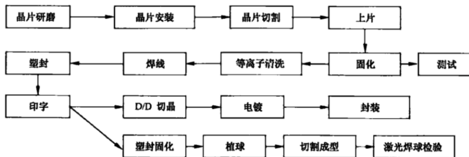
图 A.2 集成电路封装与测试工艺流程简图
