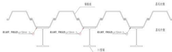
图 5.3.1-1 外置型组合钢板桩支护焊接连接
