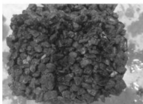
(c) 粗骨料与水泥浆脱落
