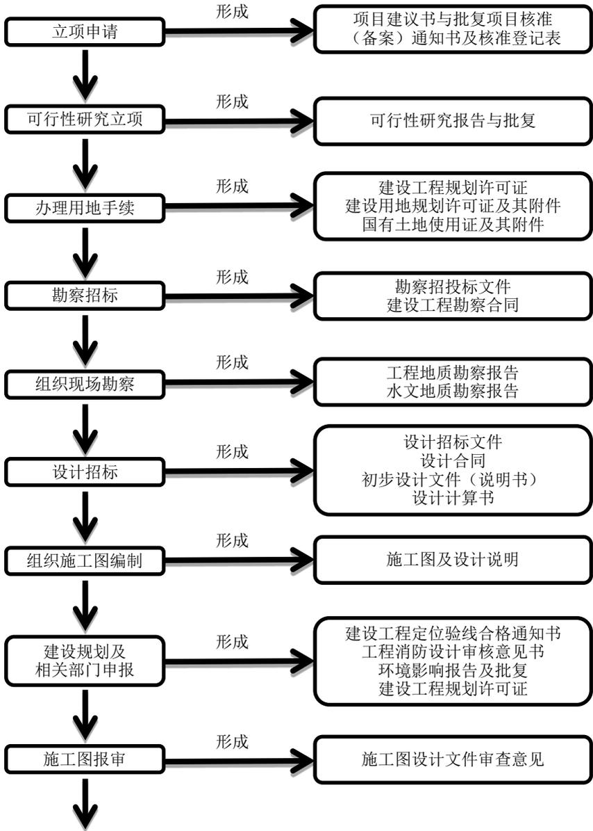
图 6.0.2 基本建设文件形成流程图
