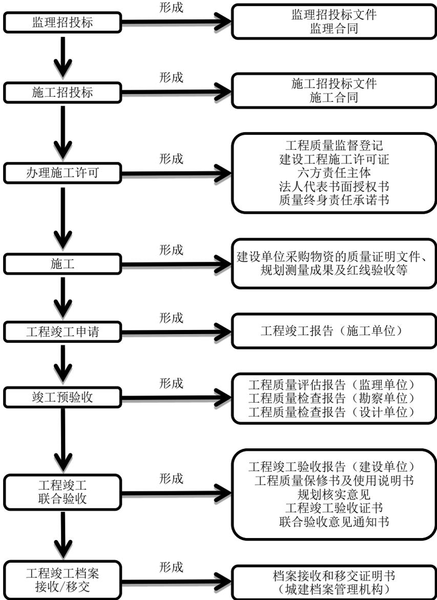
图 6.0.2 基本建设文件形成流程图（续）
