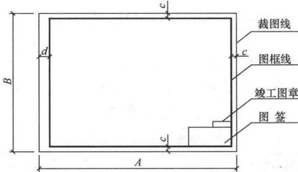
图 D.2.1 图框及图纸边线尺寸示意
