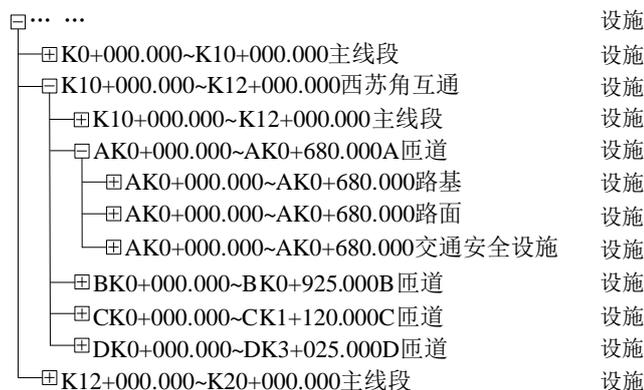
图E.3 互通匝道公路段设施分解示例
