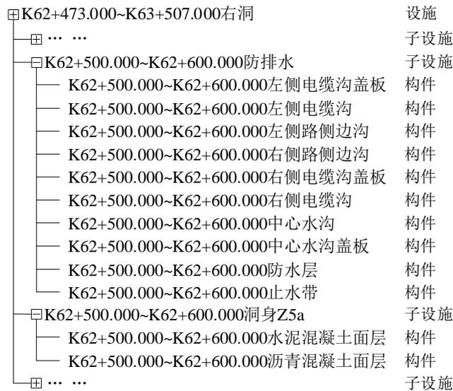
图E.16 路面（段）、防排水子设施分解示例
