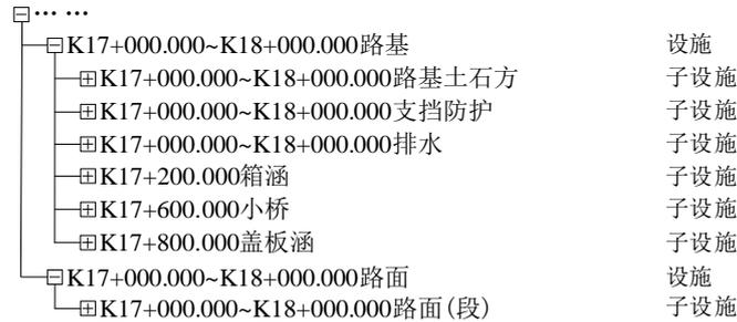
图E.5 路基、路面设施分解示例
