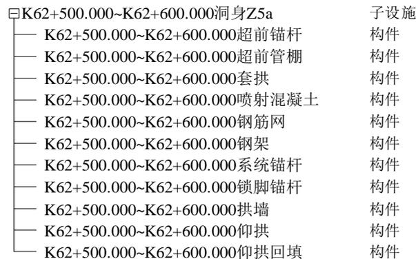
图E.15 洞身子设施分解示例
