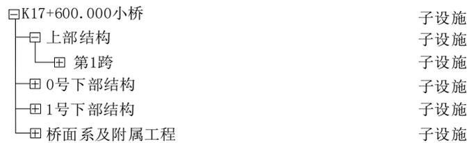
图E.10 小桥子设施分解示例
