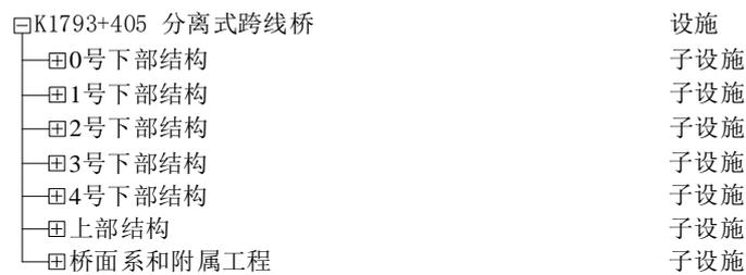
图E.19 示例桥梁设施分解
