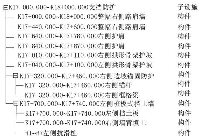
图E.8 支挡防护子设施分解示例
